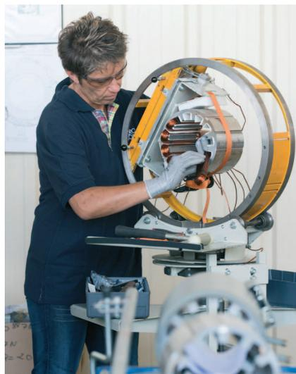
*Per particolari applicazioni, l'avvolgimento dello statore viene realizzato completamente a mano*
