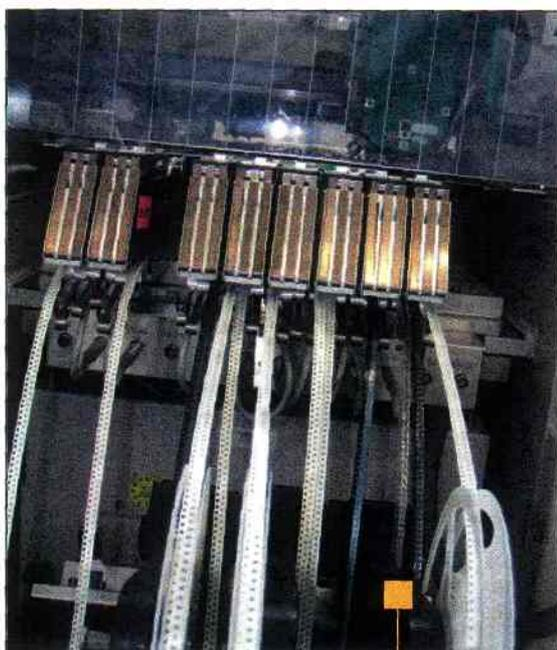
Bobines de composants montés à la surface des cartes électroniques.
