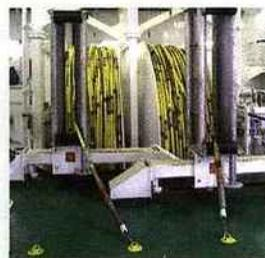
**Les dispositifs** d'enregistrement de données sont principalement composés de streamers ou câbles contenant des hydrophones.
