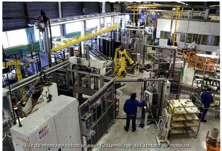
Ilôt de montage robotisé pour l'assemblage des stators de moteurs.
