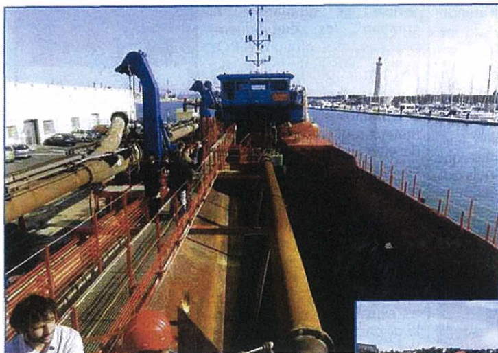
La drague vue de son avant Sur la gauche, le retour du tuyau de pompage.
