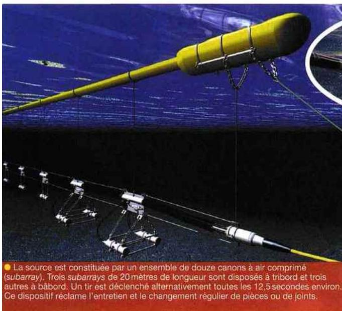
● La source est constituée par un ensemble de douze canons à air comprimé (subarray). Trois subarrays de 20 mètres de longueur sont disposés à tribord et trois autres à bâbord. Un tir est déclenché alternativement toutes les 12,5 secondes environ. Ce dispositif réclame l'entretien et le changement régulier de pièces ou de joints.
