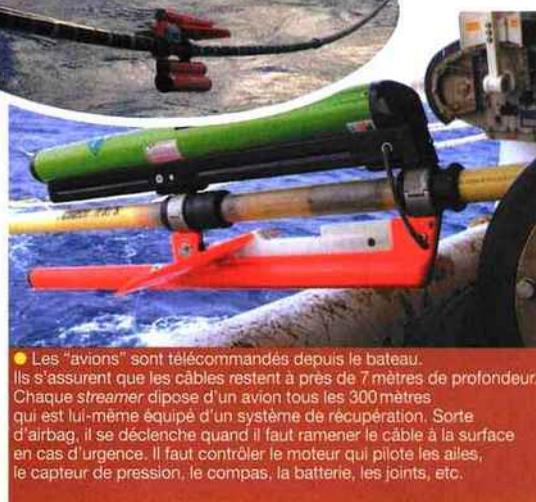
● Les "avions" sont télécommandés depuis le bateau. Ils s'assurent que les câbles restent à près de 7 mètres de profondeur. Chaque streamer dispose d'un avion tous les 300 mètres qui est lui-même équipé d'un système de récupération. Sorte d'airbag, il se déclenche quand il faut ramener le câble à la surface en cas d'urgence. Il faut contrôler le moteur qui pilote les ailes, le capteur de pression, le compas, la batterie, les joints, etc.
