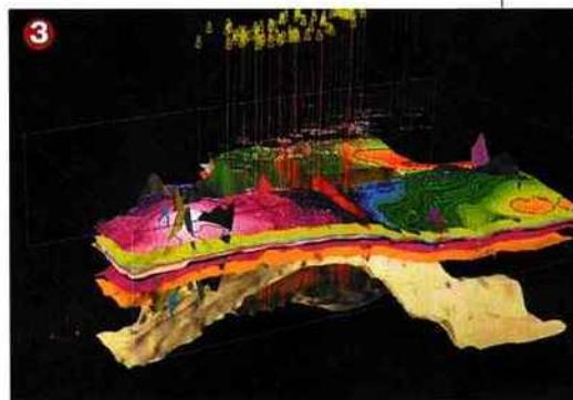
●● L'acquisition sismique est une mesure indirecte qui consiste à enregistrer en surface des échos issus de la propagation dans le sous-sol d'une onde sismique provoquée par des canons d'air comprimé (1). Ces échos sont générés par les hétérogénéités du sous-sol. Certains types de roches filtrent les ondes
