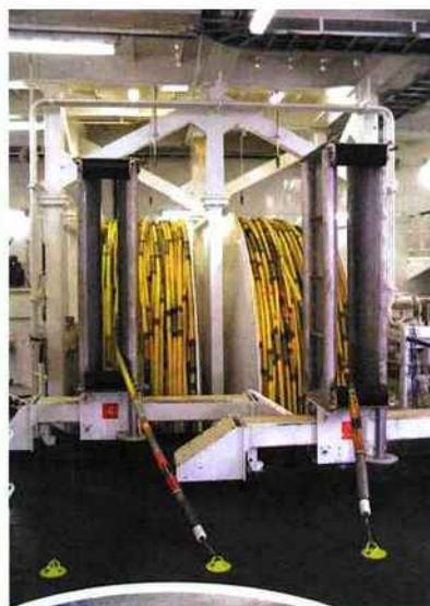
● Les streamers qui atteignent jusqu'à 8 km de longueur intègrent un hydrophone tous les 12,5 mètres. Ces derniers enregistrent les signaux sismiques. Ils mesurent les changements de pression qui se produisent au fur et à mesure que le son se propage dans l'eau.
