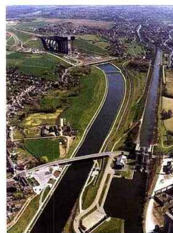
Vue générale du nouveau canal à 2000 t et du canal historique à 300 t avec un des quatre ascenseurs hydrauliques datant de 1888.
