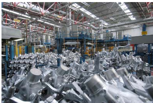
Vista de la fábrica de fundición de Brembo en Mapello, construida en el año 2003. Un paseo por la instalación permite observar equipos como hornos para la fusión del aluminio, máquinas de coladas por gravedad o baja presión, sierras de corte robotizadas que funcionan de forma automatizada y máquinas de tratamiento térmico.
