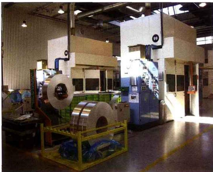
Dans le projet Carl Mobility, les lignes de production feront l'objet d'une décomposition en sous équipement. Sur cette ligne de découpage, la presse aura un code-barre, l'aménagement un autre, le redresseur un troisième... directement scannés par l'opérateur de maintenance.
