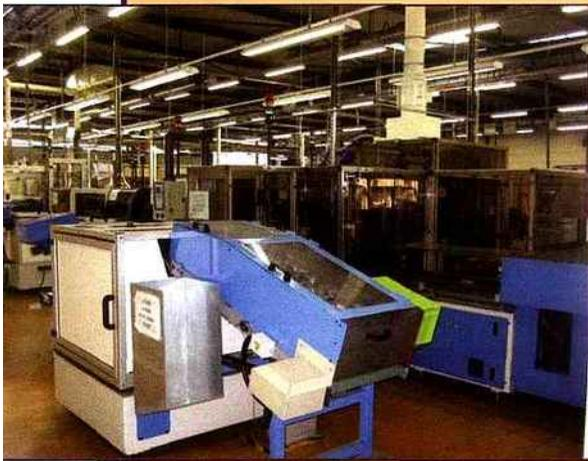
Ligne d'assemblage automatisée, destinée à la fabrication de systèmes de régulation de turbo.
